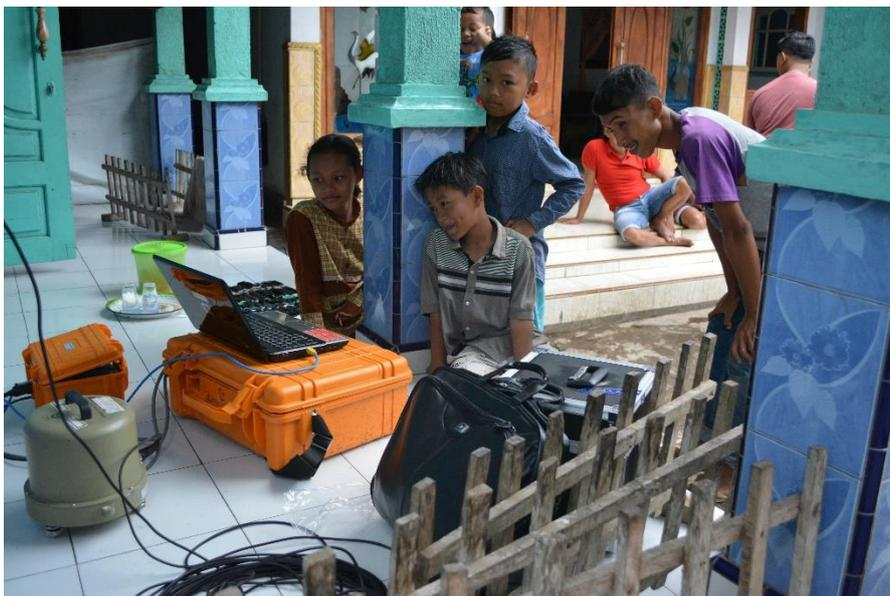
Proses pemantauan getaran tanah menggunakan portable digital seismograph
